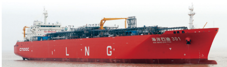
"HAI YANG SHI YOU 301", 30,000 m 3 Type C independent tank LNG carrier
